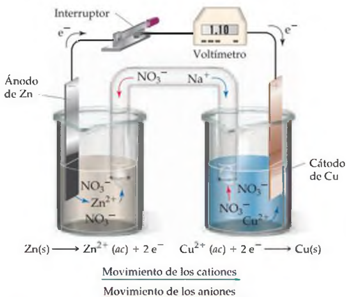
▲ Figura 20.5 Una celda voltaica que utiliza un puente salino para completar el circuito eléctrico.
